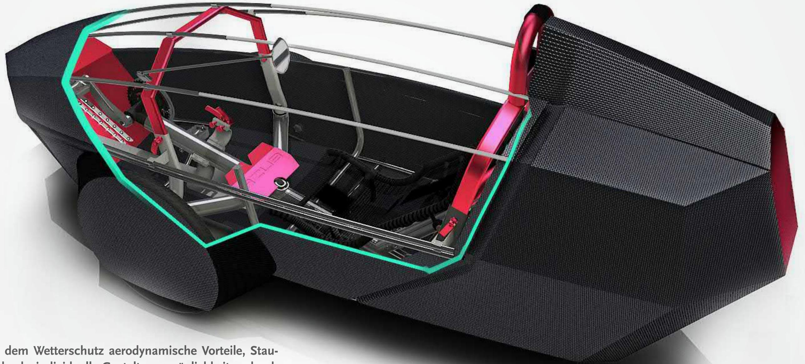
Die Verkleidung bietet neben dem Wetterschutz aerodynamische Vorteile, Stauraum im hinteren Bereich und sehr individuelle Gestaltungsmöglichkeiten durch Drucke oder Schnitte.
